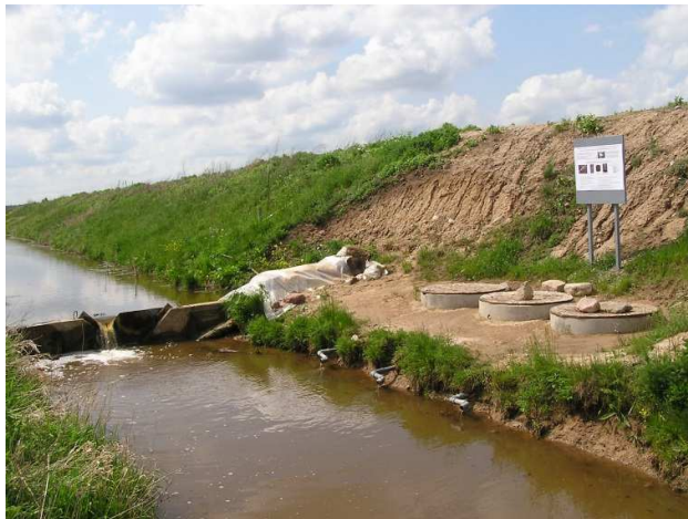
3.1.1.11 pav. Griovių filtrų su fosforą adsorbuojančiomis medžiagomis tyrimai Krekenavos bandymų objekte (Nevėžio pabaseinis)
