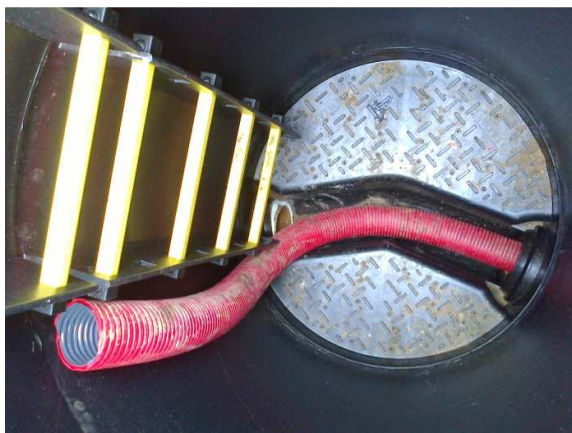
3.1.1.18 pav. Drenažo vamzdis vandens ištekėjimo lygiui reguliuoti (kairėje), įranga drenažo nuotėkiui matuoti šulinio viduje (dešinėje)
